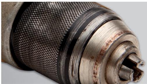
Beschädigtes Bohrfutter - Werkzeug nicht gepflegt
